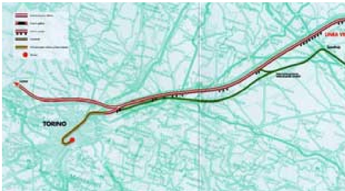
Il tracciato tra Torino e Novara corre in rilevato per la maggior parte della tratta (66,2 km + 14,2 km di interconnessioni). È inoltre prevista la costruzione di oltre 15 km di viadotto e circa 2,5 km di galleria artificiale.
